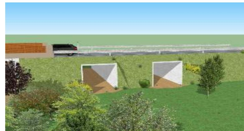
Figure 41 : Exemple de passage à faune sous-infrastructure routière (sans entonnement ici)
